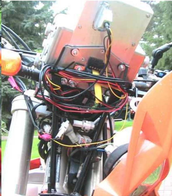
Links ohne Kabelführung und rechts ist alles sorgfältig verlegt und befestigt.
