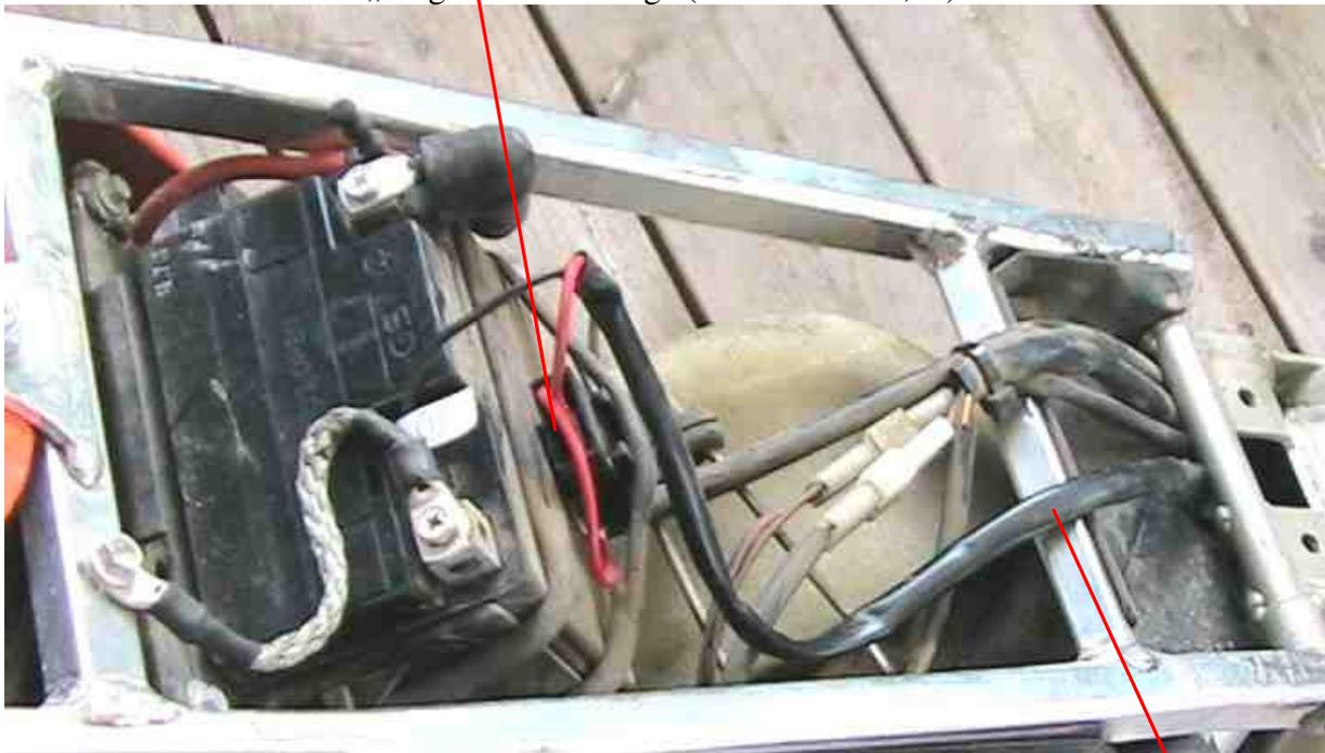
angeschlossen, im Original ist eine 5 A drin die müsste auch gut passen denke ich. An dem Teil ist ein 2fach Stecker dran, den ich auch benutzt (siehe weiter unten) habe. Das Kabel unter Sitzbank und Tank verlegen, zugfrei mit Kabelbindern befestigen und unter der
